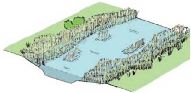
Natuurvriendelijke oevers verhogen de ecologische waarde en tevens de capaciteit voor waterberging.
